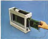
A sinistra: l'installazione rapida. A destra: la posizione delle schede principali rispetto agli slot di espansione. Al centro: due schede da espansione: quella sinistra è l'interfaccia floppy, l'altra è una RAM di 256 Kbyte.
